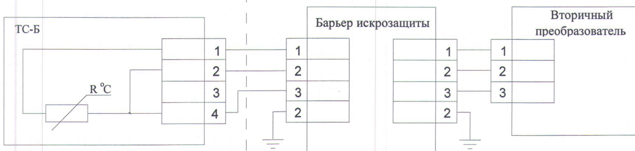
Рисунок В.4 Схема подключения взрывозащищенного ТС-Б, с видом взрывозащиты «искробезопасная цепь» уровня «ia», с 3-х проводной схемой подключения к вторичному преобразователю (устройству индикации) .
