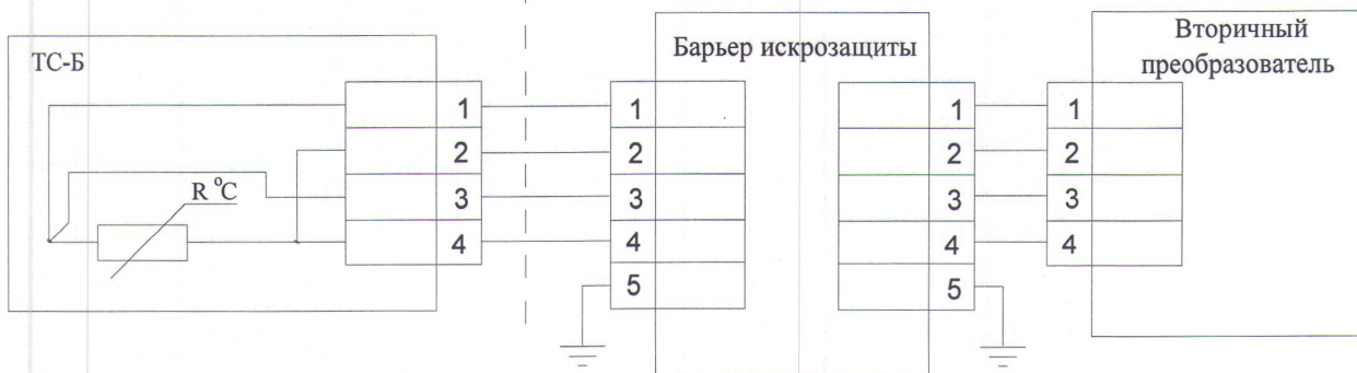
Рисунок В.5 Схема подключения взрывозащищенного ТС-Б-Р, с видом взрывозащиты «искробезопасная цепь» уровня «ia», с 4-х проводной схемой подключения к вторичному преобразователю (устройству индикации) .
